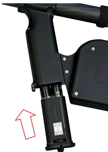
Рисунок 10 – Установка аккумуляторов
